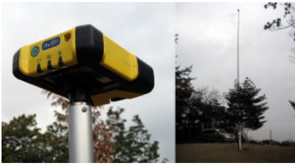
図-1 Pathfinder ProXH と GPS アンテナポールを用いた測位実験の風景
